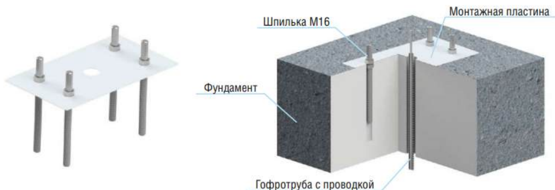
Рисунок 20. Устройство фундамента с монтажным комплектом.
