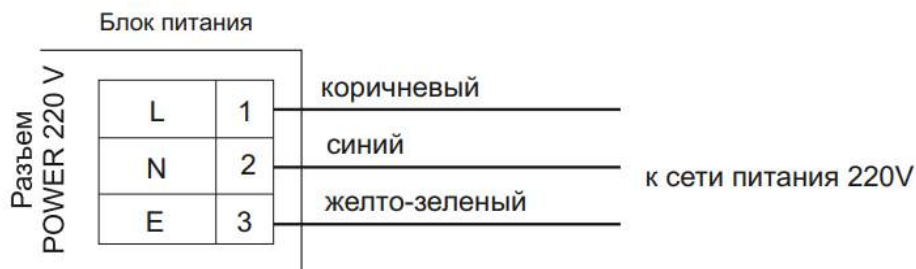
Рисунок 26. Схема подключения блока питания
